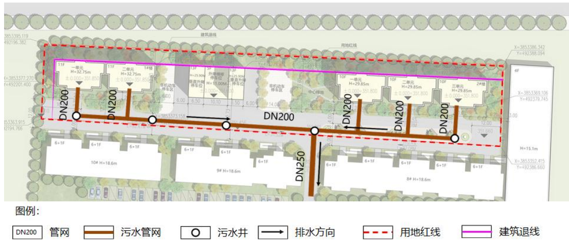
图 1.2-2 项目区内室外污水总平面图
